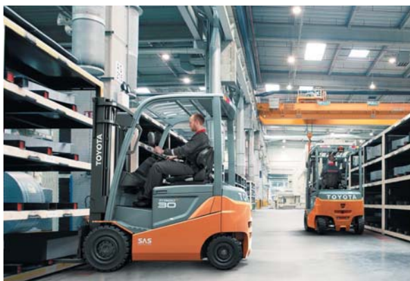
Мотокарите Toyota Tonero HST са с хидростатично задвижване
